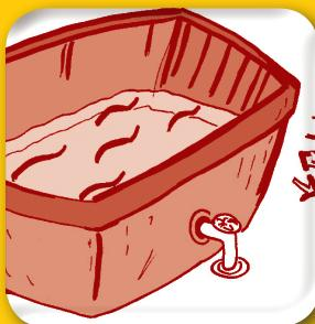
2. Quando a caixa estiver quase vazia, feche a saída e utilize a água que restou para a limpeza da caixa e para que a sujeira não desça pelo cano.
